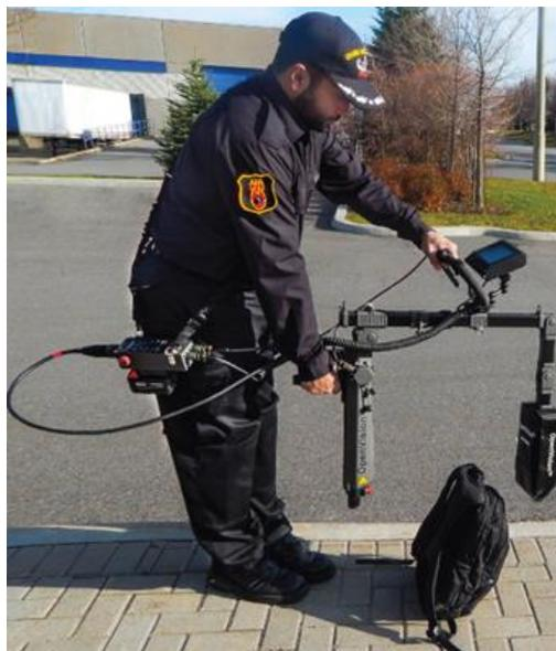
OpenVision は、リアルタイムで映像を確認できる最新型の X 線装置です。持ち運び型の本装置は、照射器、受像板およびモニターが一体となっている完結型の装置となっており、従来型の X 線装置のように、受像板の取出しや離れた場所での確認作業は必要ありません。対象物に対し、あらゆる角度から、迅速に X 線検査の作業が可能です。
