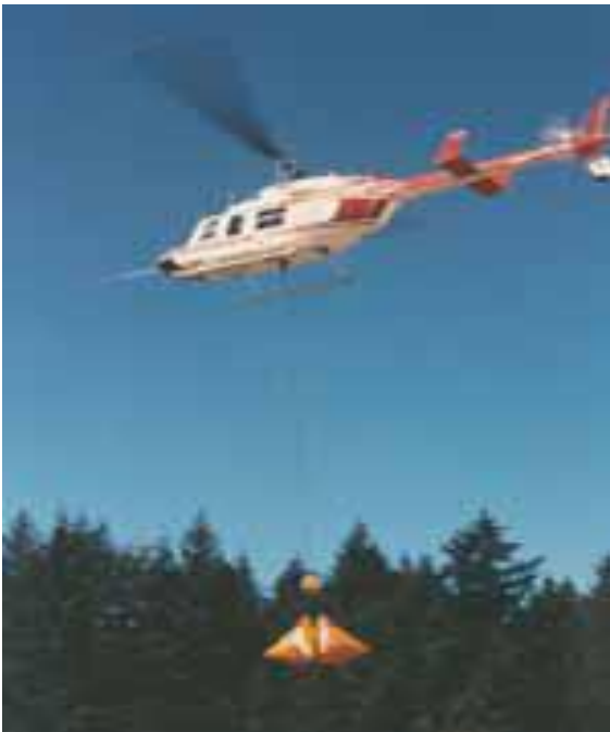
ヘリ輸送中の水槽タンク
