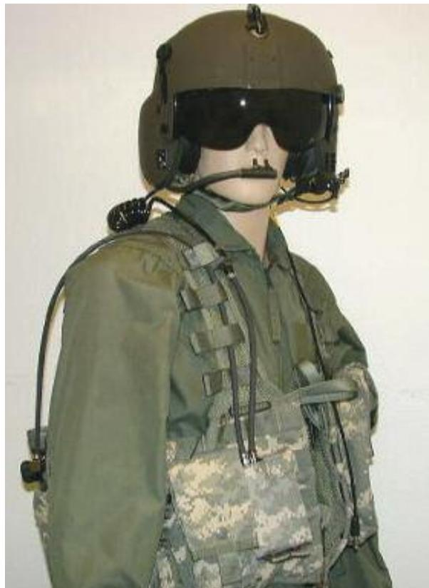
PHODS 携帯型ヘリコプター酸素送達システムは、高高度における飛行及び地上ミッションをサポートするため、搭乗員の飛行ベストやヘルメットに直接取り付けることが可能な、酸素システムである。鋼鉄製の酸素ボトルは難燃性のポケットに入れて、飛行ベストに取り付ける。
